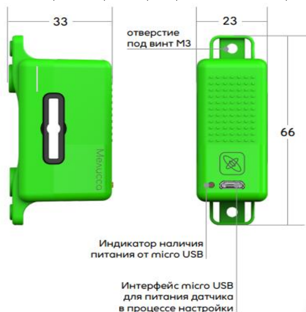
Рисунок Д.1 – Внешний вид и габаритные размеры температурного датчика Мелисса
